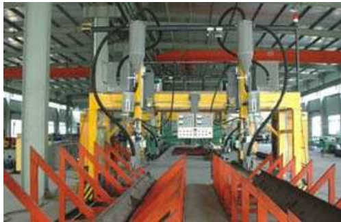
MÁY HÀN ĐỈNH MÁY, HÀN LIÊN TỤC DÀM CHỮ H SPOT WELDING AND SUBMERGED ARC WELDING MACHINE
